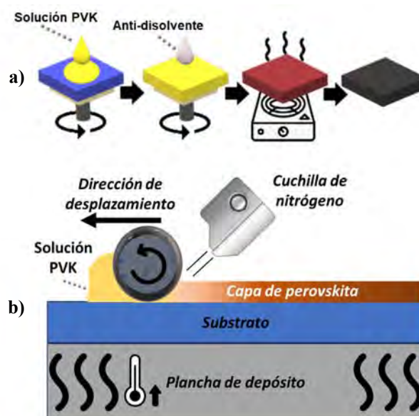
FIGURA 1. Diagrama del proceso de a) depósito por rotación (Spin-Coating) y b) depósito por barra (DBr) para la fabricación de películas de perovskita.
