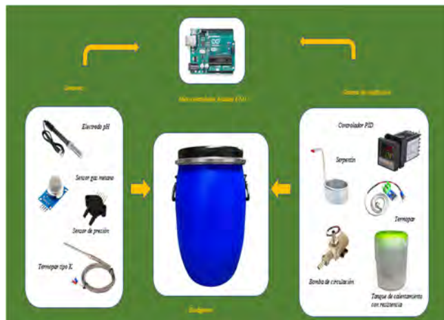
FIGURA 1. Sensores y controladores empleados en el diseño del biodigestor.
