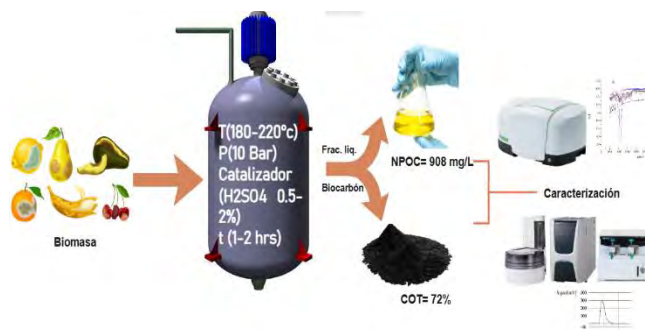
FIGURA 1. Esquema de la producción de biocarbón por proceso hidrotérmico y caracterización de los productos
