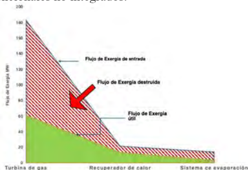
FIGURA 4. Distribución de los flujos de exergía en el sistema de desalinización
