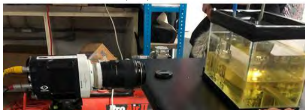
FIGURA 3. Arreglo experimental con las pinzas mecánicas bioinspiradas y la cámara Phantom Miro M310.
