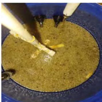
FIGURA 2. Carga de residuos sólidos orgánicos en el biodigestor.
