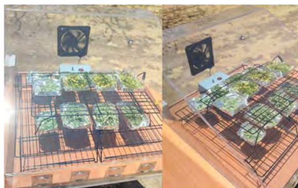
FIGURA 1. Secador solar de gabinete en funcionamiento.
